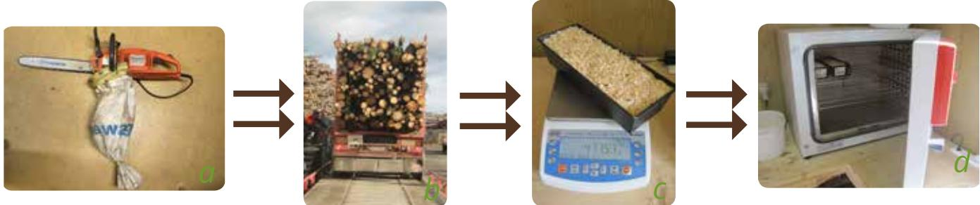
Kvaliteta mora biti ocijenjena i izmjerena u SLC-u. Sadržaj vlage je jedna od najvažnijih mjera kvalitete. Na slikama možete vidjeti uzimanje uzorka ulazne sirovine i mjerjenje vlage prema ISO standardu:
